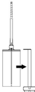
**Nota:** la boquilla QH cuenta con dos secciones. Una sección contiene los elementos de mezcla y la otra sección consiste en una pieza de extensión. Conecte la pieza de extensión a la sección de mezcla presionando las dos secciones juntas firmemente hasta que se note la unión.
