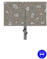
El exceso de resina se expulsará del orificio de manera uniforme alrededor del elemento de acero y no deberá haber espacios entre el elemento de anclaje y la pared del orificio perforado.
