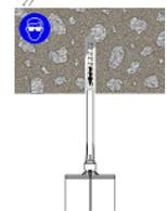
11. Seleccione el elemento de anclaje de acero asegurándose de que esté libre de aceite u otros contaminantes y marque la profundidad de empotramiento necesaria. Inserte el elemento de acero en el orificio con un movimiento giratorio hacia adelante y hacia atrás para asegurar una cobertura completa, hasta que alcance el fondo del agujero.
